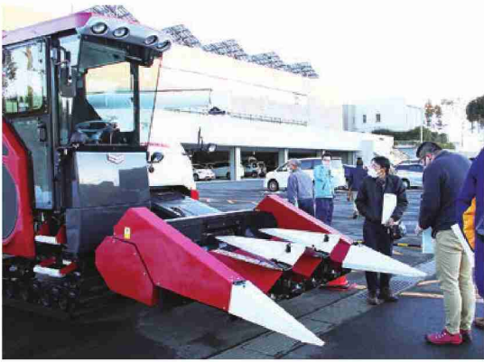
研修会場では、汎用型コンバインにトウモロコシ用のアタッチメントを付けた機械を展示しました
