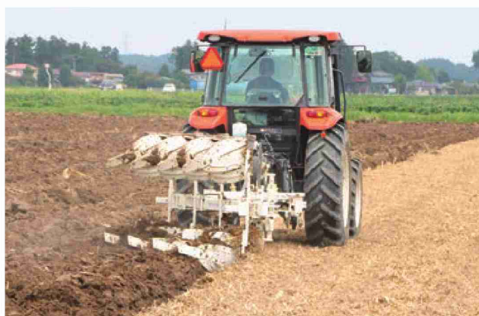
リバーシブルプラウで真下にすき込む
